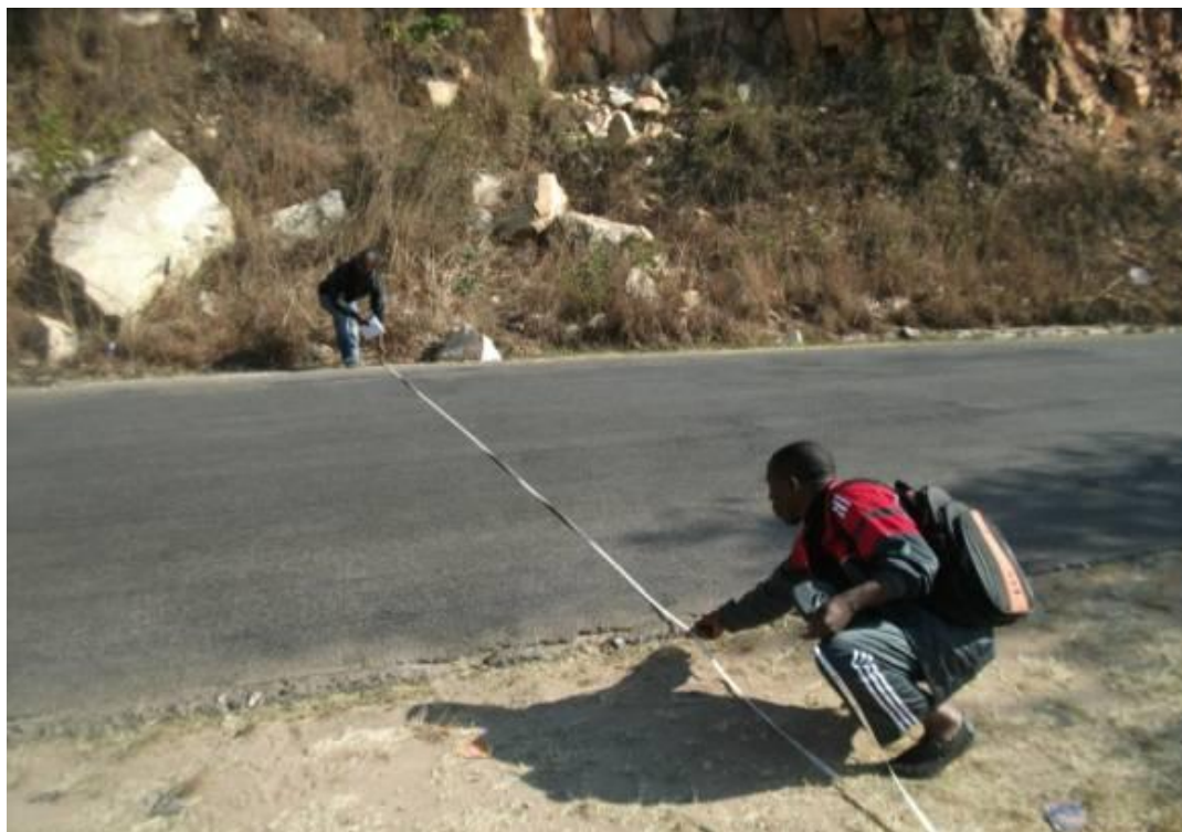
Figura 5.7 – Medição da largura da rodovia.
