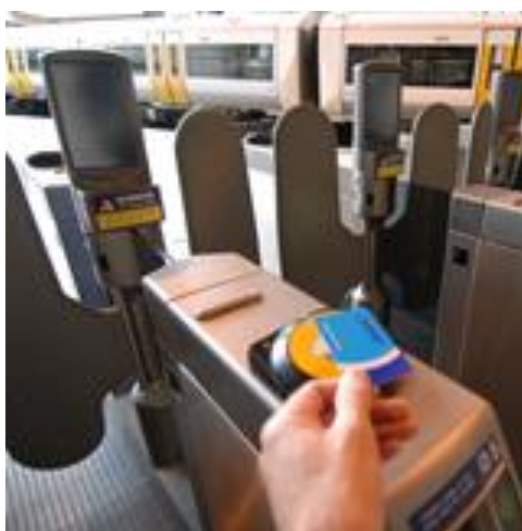
Figura 3.2 - Processo de validação automática do oyster card em Londres (tfl.gov@2011)
