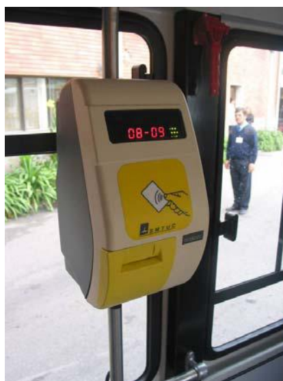
Figura 4.5 - Dispositivo de validação electrónica do título de transporte dos SMTUC (Stüssi e Miguel, 2007)
