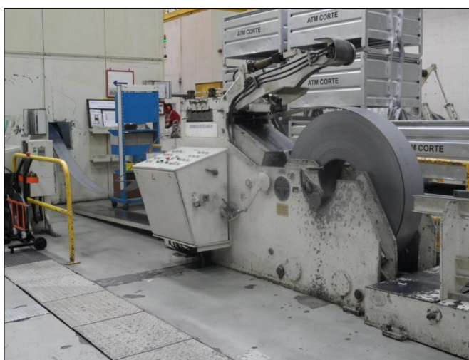
Figura 4: Desenrolador da prensa 250 Toneladas.
