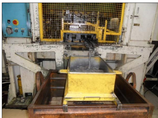
Figura 5: Prensa 250Ton e 300 Ton, respetivamente
