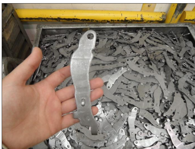
Figura 7: Alavanca Dácia depois de dobrada.
