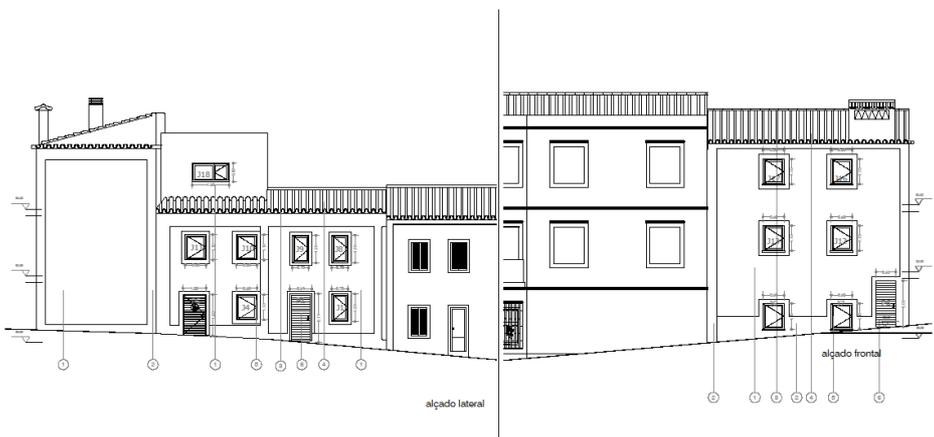
1. Paredes exteriores entrocadas ou recuperadas com argamassa bastarda e pintada com tinta branca à base de silício.
