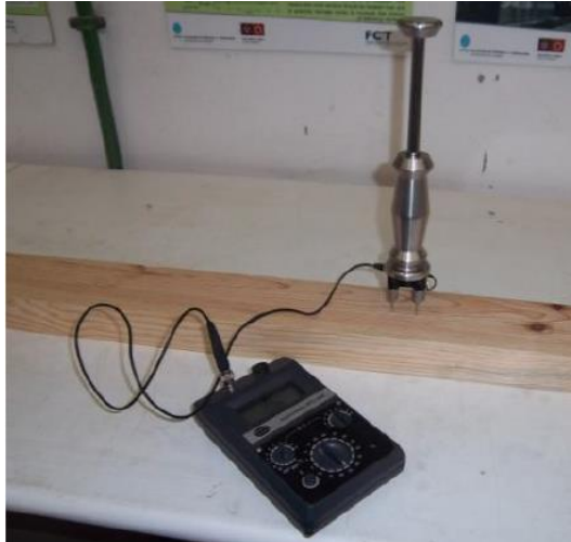
Figura 3.1-Humidímetro de agulhas, para medição do teor de água nos provetes
