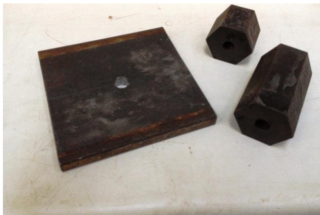
Figura 3.6-Porcas sextavadas e chapa metálica, utilizadas no ensaio de pós-tensão
