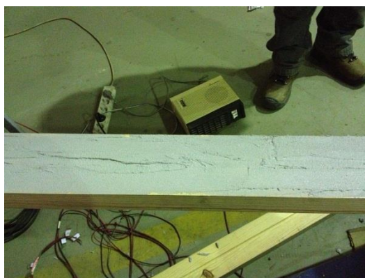
Figura 4.9-Lamela de madeira com Sikadur 30N
