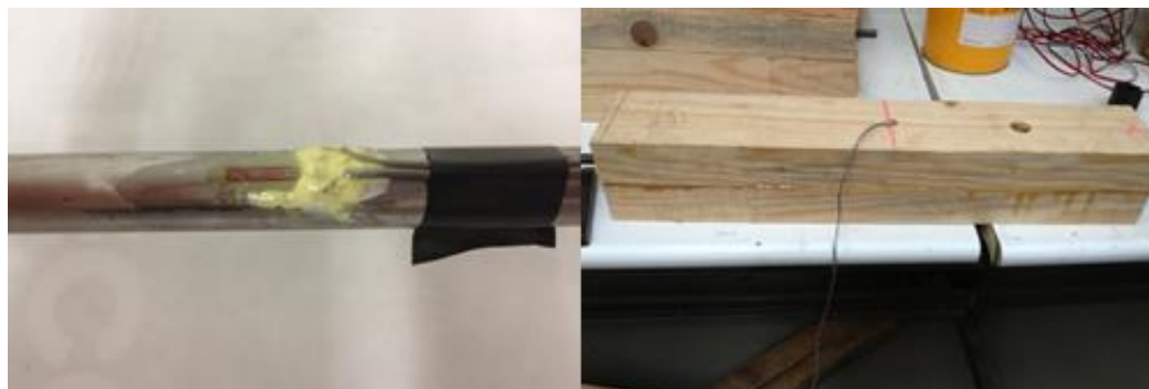
Figura 4.11- Extensómetro instalado no fio de aço
