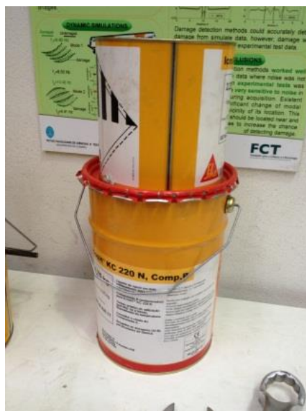
Figura 3.4- Cola utilizada para a colagem das lamelas (Icosit KC220N)
