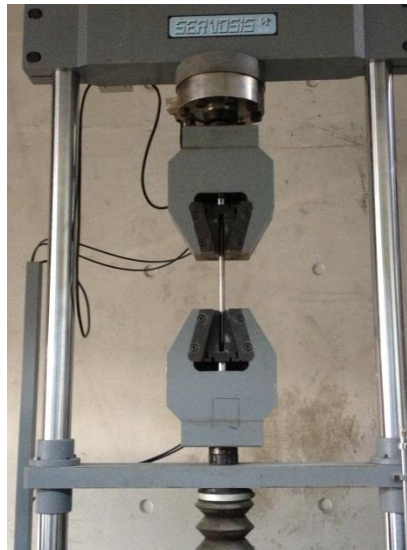
Figura 4.2-Ensaio na máquina universal de tração/ compressão de 200kN
