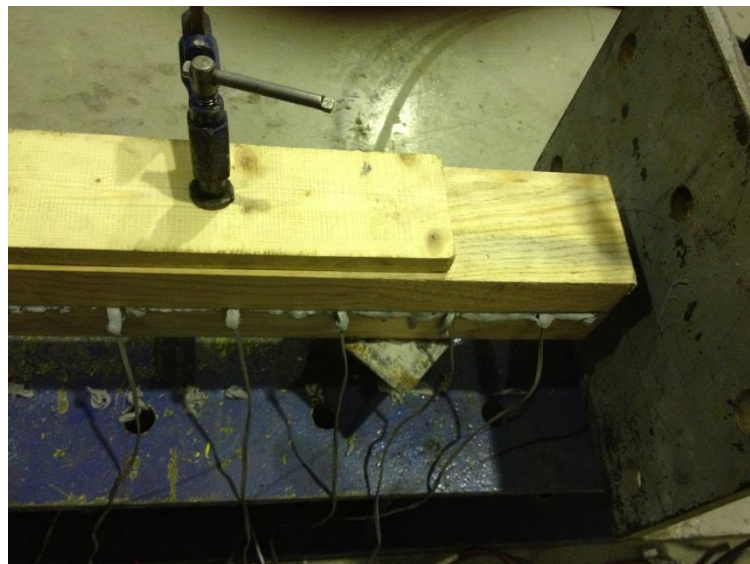
Figura 4.30- Passagem dos fios do extensômetro
