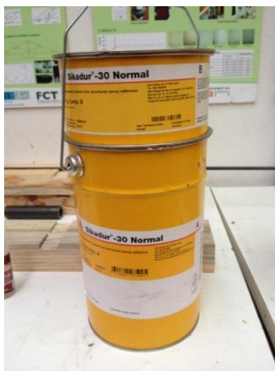
Figura 3.5-Cola utilizada para aderir o fio de aço pré-esforçado à madeira no ensaio de pré-tensão (Sikadur 30 Normal)
