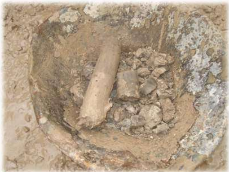
تصویر ۲-۹) نمونه ها بعد از بیرون آوردن از استوانه نمونه گیر
