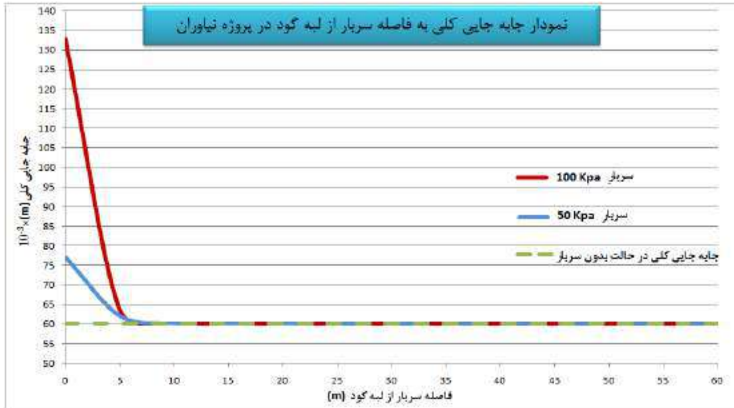
نمودار ۱-۳-۳) جابه جایی کلی به فاصله سربار از لبه گود در پروژه نیاوران
