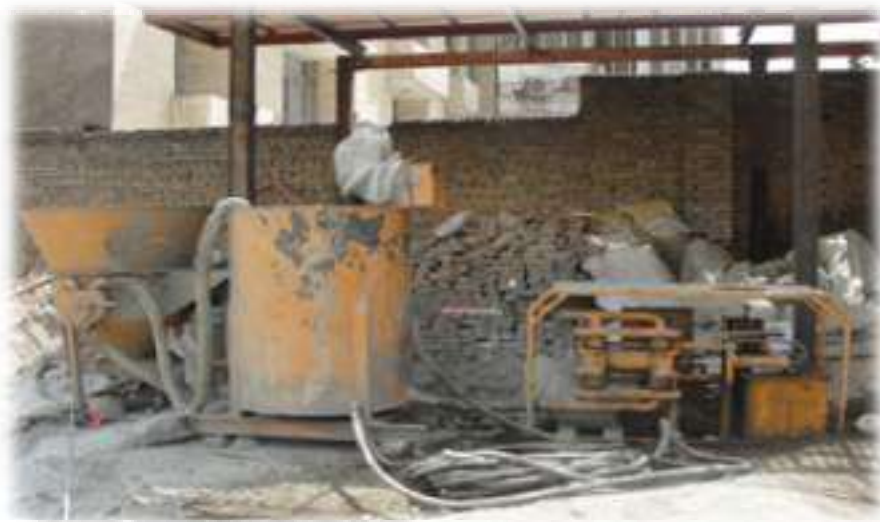
تصویر ۲-۱۴) دستگاه تزریق دوغاب؛ شامل میکسر، همزن و پمپ تزریق
