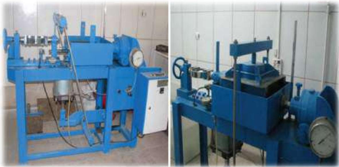
تصویر ۲-۳) دستگاه برش مستقیم و نمایی از انجام آزمایش در حین بارگذاری
