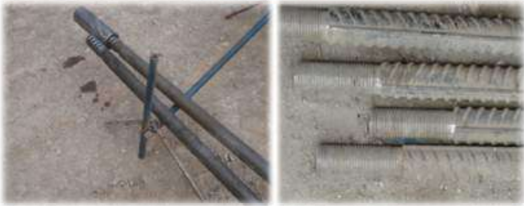
تصویر ۲-۱۳) میله‌های فولادی (Nail) در نوع خود حفاد و میلگرد سر رزوه
