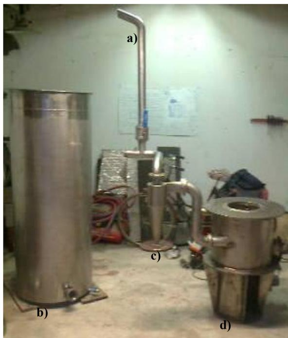
Figura 3.3 - a) Depósito de combustível, b) Flare, c) Ciclone e d) Base do gaseificador.
