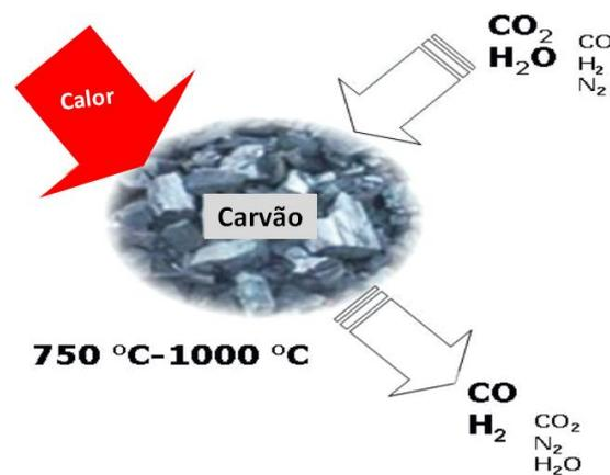
Figura 2.11 - Esquema do processo de gaseificação (Adaptada de BARRIO, 2002, *Experimental investigation of small-scale gasification of woody biomass*).
