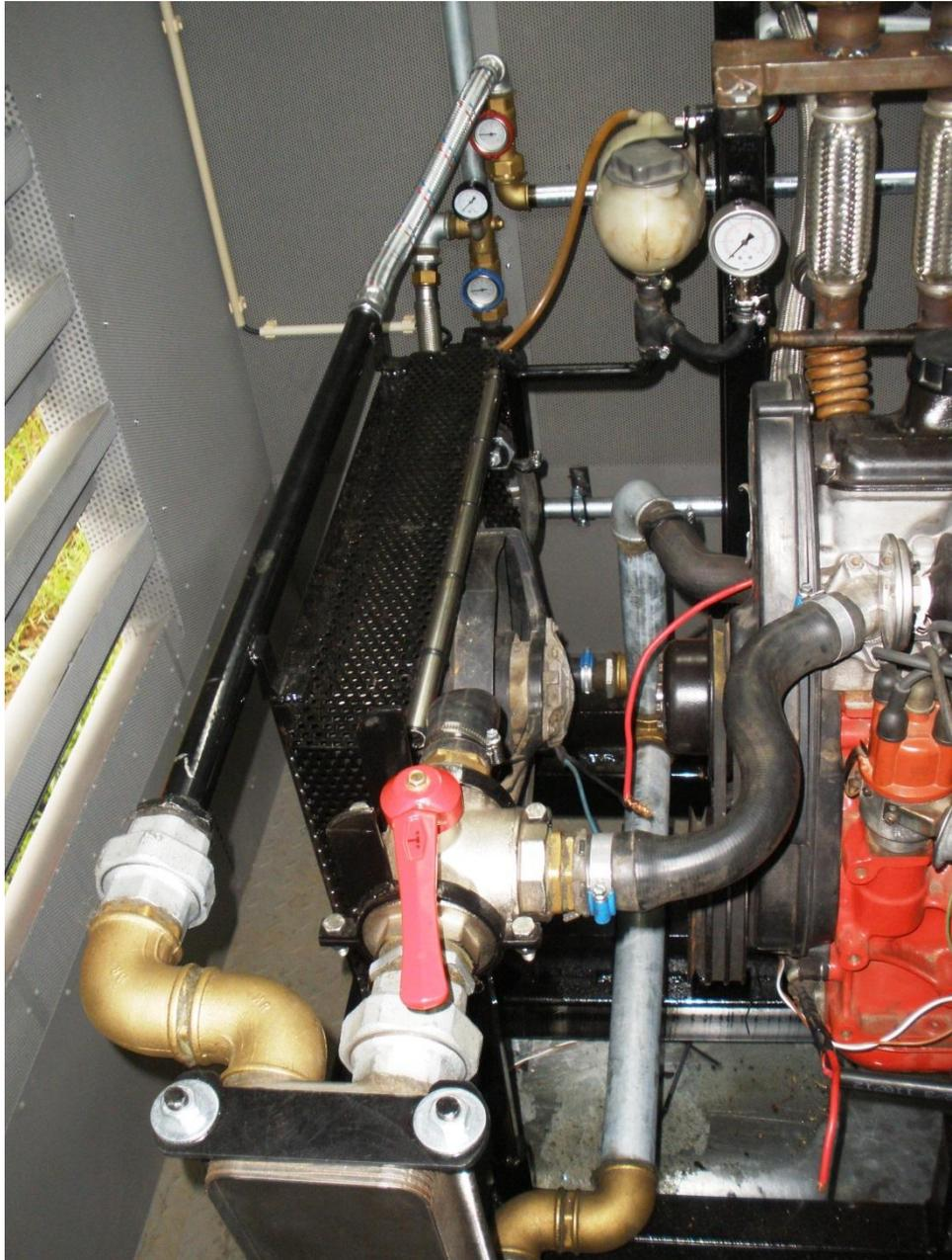
Figura 3.12 - Vista do circuito de refrigeração do motor.
