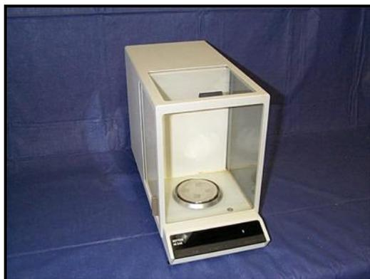
**Figura 4.4 - Balança analítica Mettler AE240, com capacidade até 40 g e com uma precisão máxima de 0,01 mg.**
