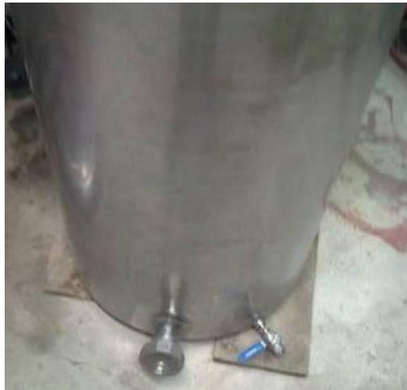
**Figura 3.2 - Depósito de combustível com a drenagem de condensados e visor de combustível.**
