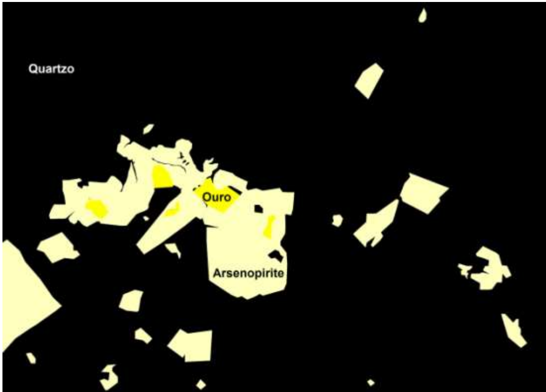
Fig. 2.5 – Esquema de uma secção polida. Grãos de arsenopirite com grãos intergranulares de ouro (Adaptado de Cerveira, 1947).
