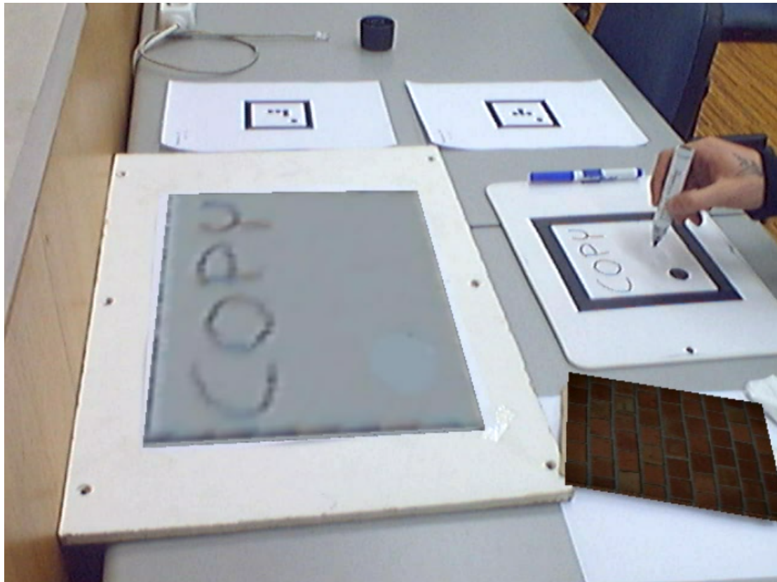
Figura 20 – Mapeamento de texturas com base na informação do marcador.
