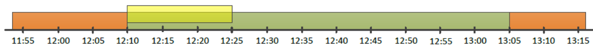
Figura 24: Cálculo do intervalo em que é possível alocar o ciclo. Laranja representa intervalos já ocupados, verde representa o slot livre e amarelo o intervalo em que o ciclo pode iniciar o funcionamento.
