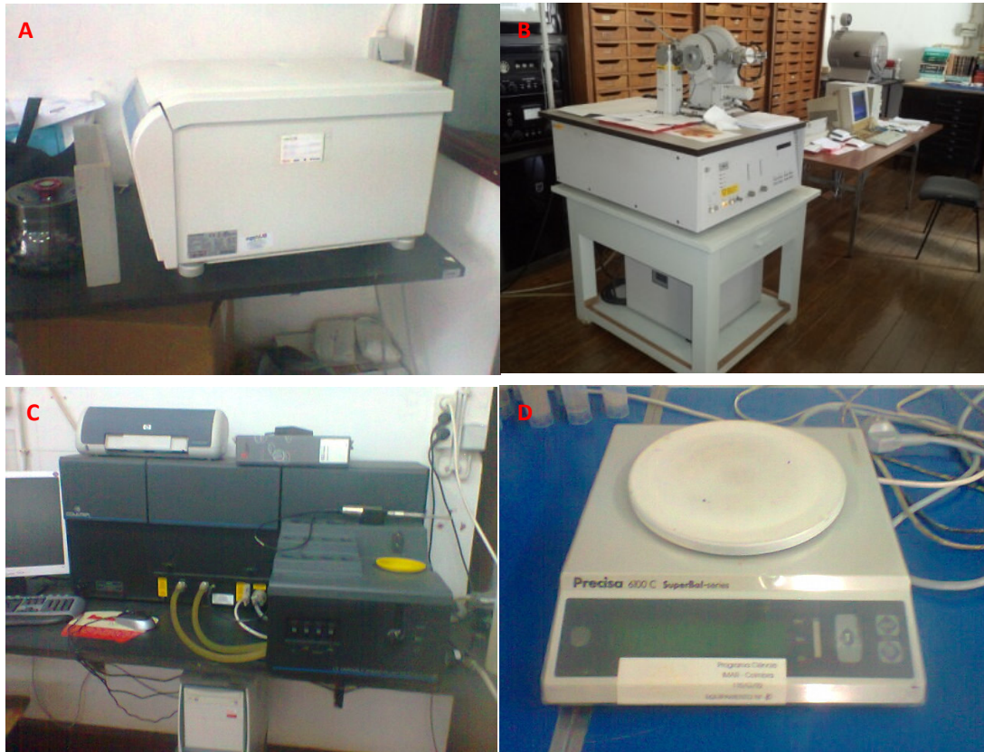
Figura 1.1. Equipamentos para a determinação da granulometria e mineralogia dos sedimentos. (A) Centrifuga Sorval –SS3; (B) Difractómetro de RX. (C) Granulómetro laser Coulter LS 230. (D) Balança digital.
