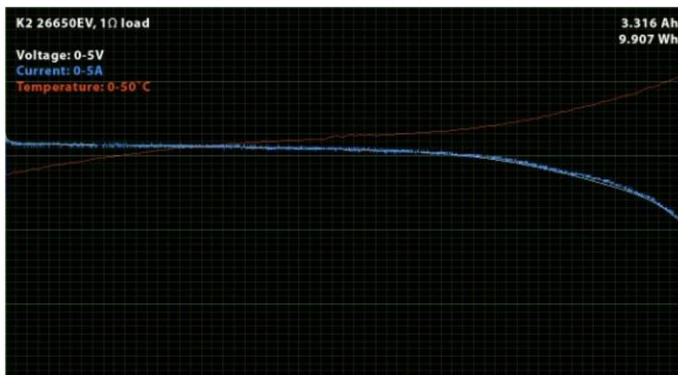
Fig. 28. Evolução da temperatura, da corrente e da tensão de uma bateria LiFePO<sub>4</sub>, na descarga a 1C [www.zeva.com.au].
