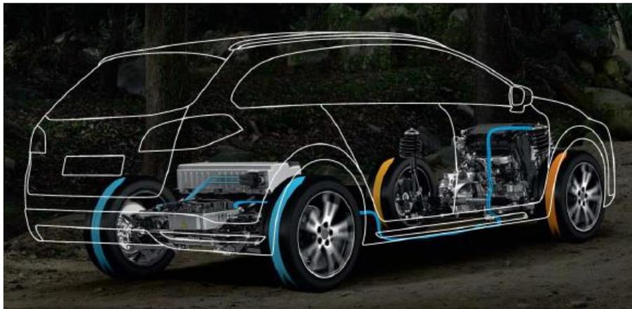
Fig. 12. Representação dos sistemas de propulsão do *Peugeot 508 RHX* [Catálogo *Peugeot 508 RHX*, 2012].
