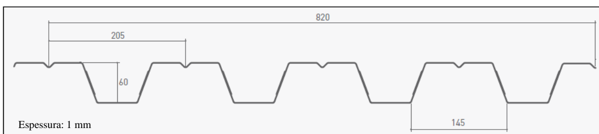
Figura 4.7 – Geometria da chapa perfilada admitida (dimensões em milímetros).
