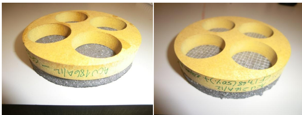
Figura 5.12 - Fotografias de provetes, com diferentes formas de colagem e respetiva “malha” da espuma autoadesiva. Amostra: ACU186A_12 e ACU216A_12
