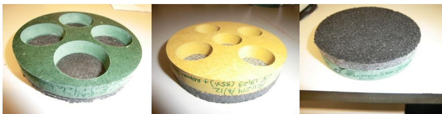
Figura 4.6 – Exemplo de provetes flocados com 10 cm de diâmetro.-
