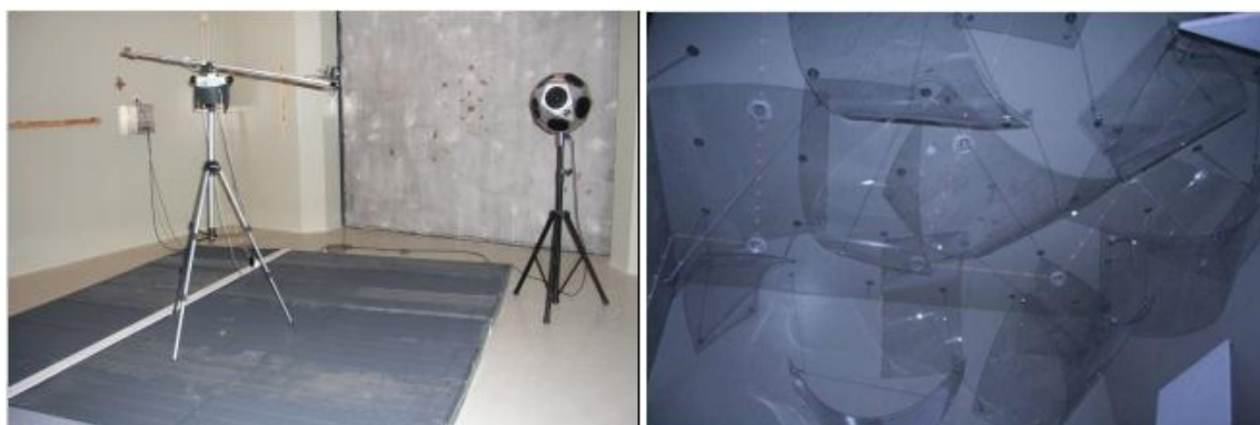
Figura 4.1 – Fonte sonora e microfone montado em girafa giratória, (à esquerda). Painéis de policarbonato, (à direita) (Jordão, 2011).
