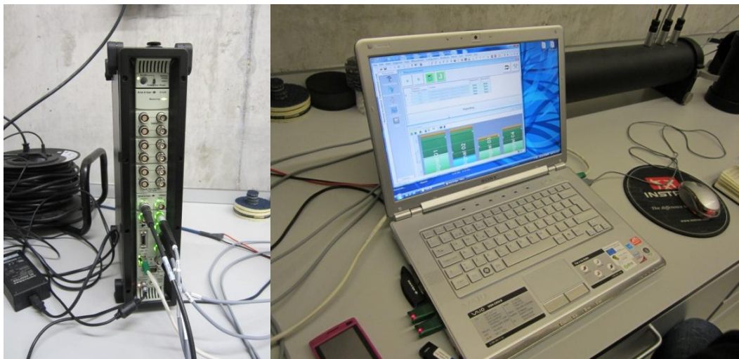
Figura 4.4 - Sistema multianalisador Pulse (à esquerda). Computador portátil com o software Pulse LabShop versão 15.1.0 (à direita).
