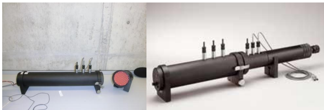
Figura 4.3 – Tubo de impedância com êmbolo para baixas frequências (à esquerda), e altas frequências (à direita).
