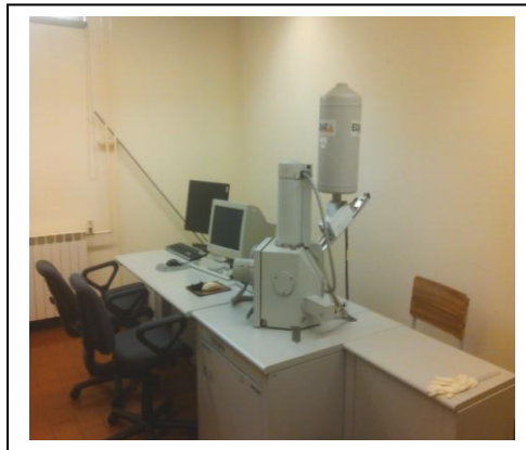
Figura 8 - Equipamento de microscopia eletrônica de varrimento equipado com espectrômetro de dispersão de energia.
