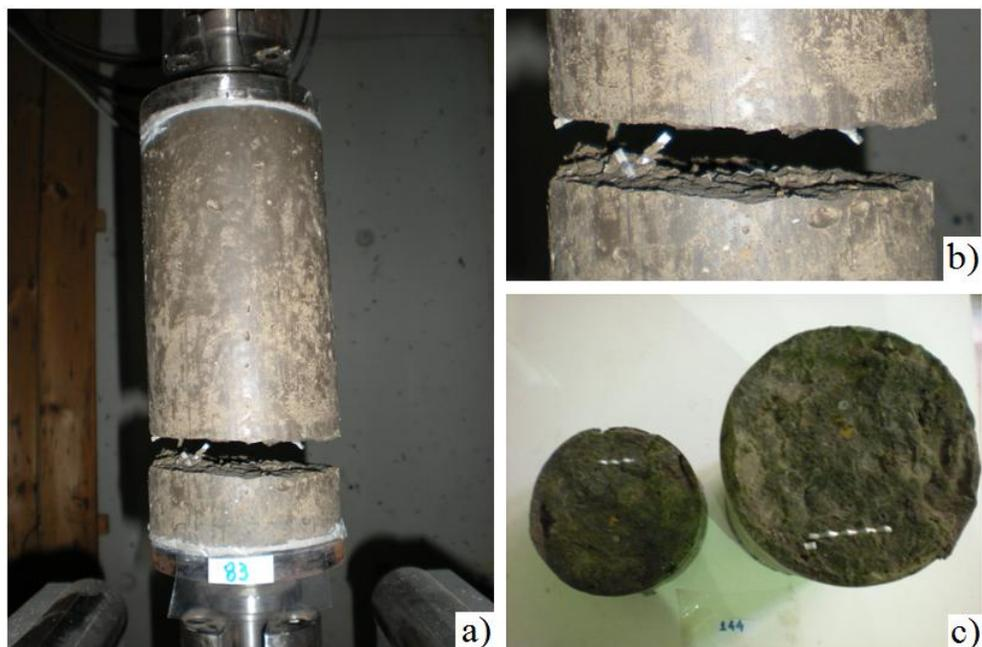
Figura 5.15 – Aspecto de superfícies de rotura obtidas em ensaios T: a) rotura do provete T375\_W50\_1; b) disposição “correcta” de fibras no provete T375\_W50\_1; c) rotura do provete T375\_W25\_2.
