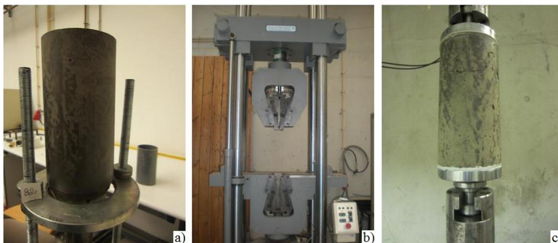
Figura 4.2 – Aparato relacionado com ensaios de tracção simples: a) desmoldagem do provete T375\_W50\_2; prensa de ensaios SERVOSIS MUF 404/100 e c) ensaio do provete T375\_W50\_2.
