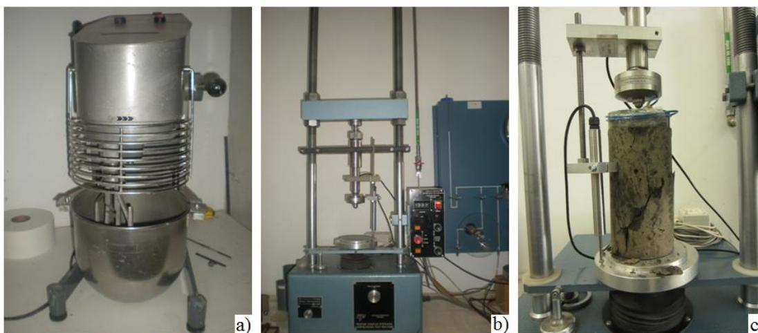
Figura 4.1 – Aparato relativo a ensaios de compressão simples: a) misturadora Samic *BM11*; b) prensa universal WYKEHAM FARRANCE LTD *Tristar 5000kg* e c) Provette UCS375\_1 após rotura.
