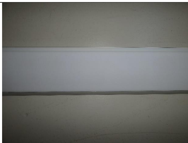
Figura 3.14 - Elemento lamela de aço com espuma absorvente
