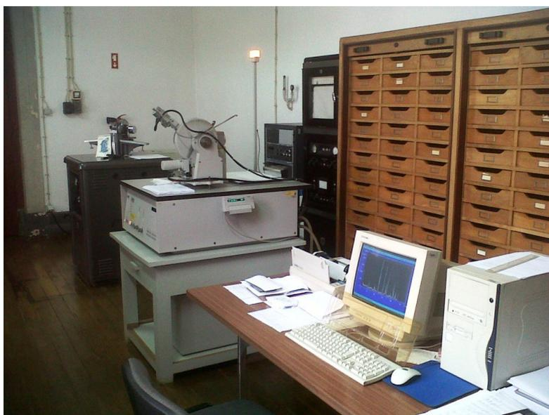
**Figura 11** - Difractómetro de raio-X “PW3710 BASED”.
