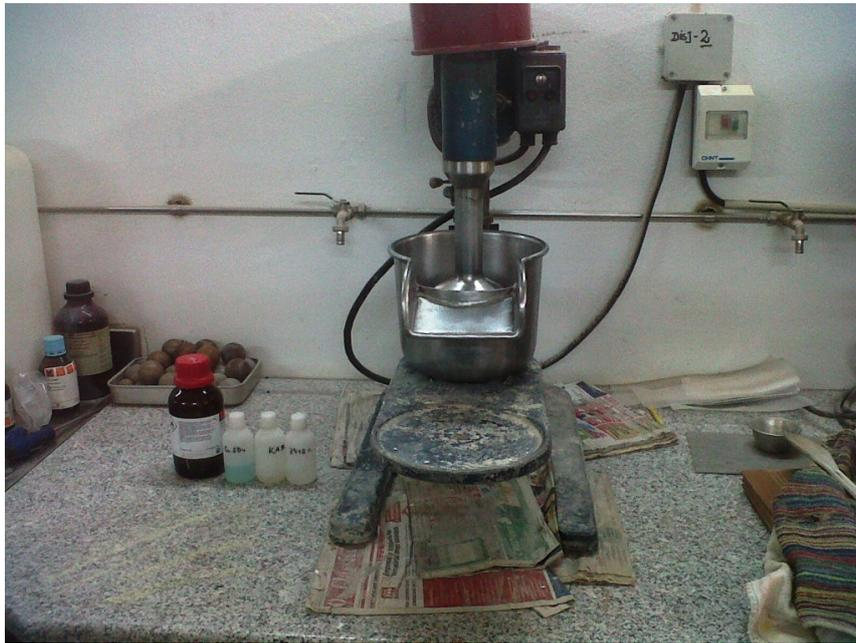
**Figura 8** - Célula de Flutuação Denver usada para os ensaios laboratoriais.
