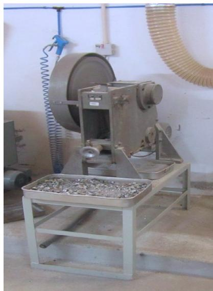
**Figura 6** - Britador de Maxilas usado para fragmentar e moer o material.
