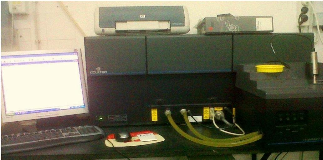
**Figura 12** - Granulómetro Laser Coulter LS230.
