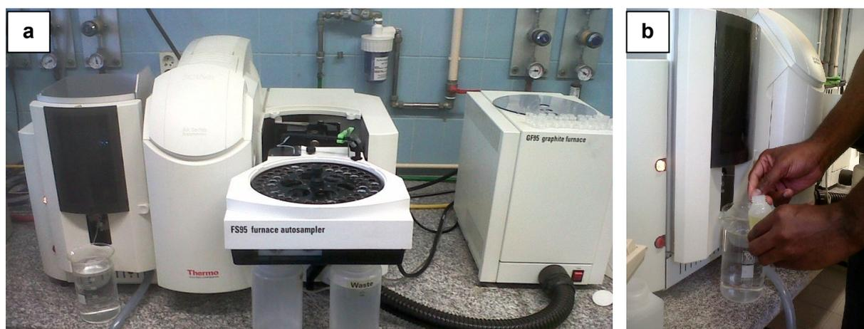
**Figura 10** - A. Espectrómetro de Absorção Atômica “Solaar MZQ Zeeman, Graphite furnace GF95, Autosampler FS95”. B. Análise química por atomizador de chama.
