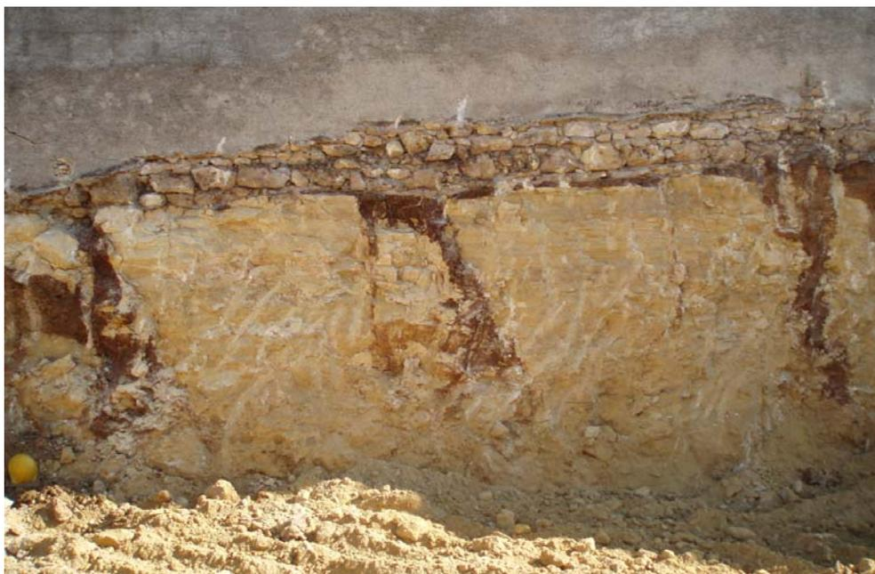
Fig. 8.1 – Material de *Terra rossa* a preencher fraturas na zona periférica à edificação.
