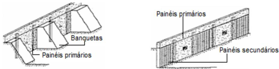
Fig. 4.3 – Fases de betonagem da parede “tipo Berlim”. À esquerda ilustra-se a betonagem dos painéis primários. À direita ilustra-se a extração das banquetas e colocação das armaduras nos painéis secundários (Adaptado de Lança (2012)).
