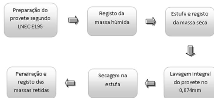
Fig. 5.2 – Procedimento 2. Análise granulométrica com lavagem integral da amostra no peneiro com malha de abertura igual a 0,074mm.
