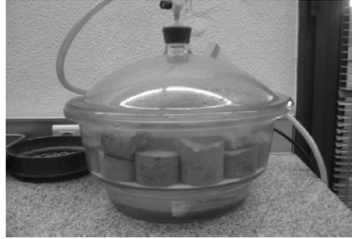
Fig. 8.41 – Saturação dos provetes de rocha em vácuo.
