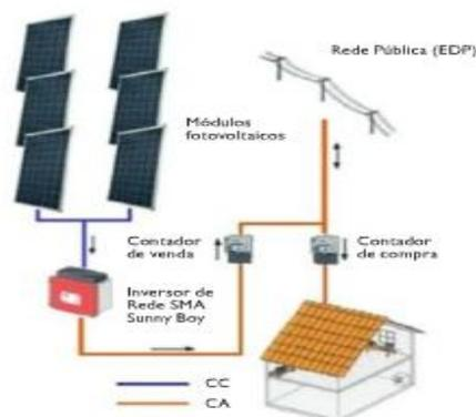
Figura 4.4 – Configuração de um sistema PV.
