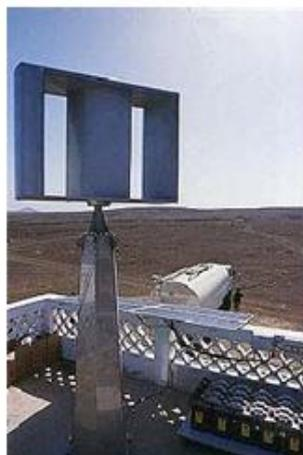
Figura 3.7 – Microgerador de eixo vertical.
