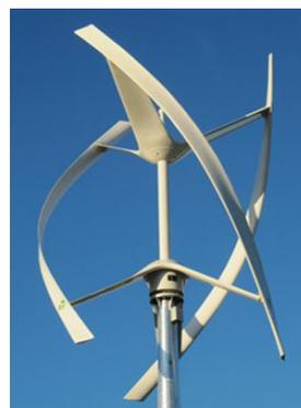
Figura 3.6 – Microgerador de eixo vertical [sasenergia@]
