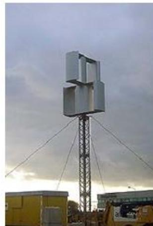
Figura 3.8 – Microgerador de eixo vertical.
