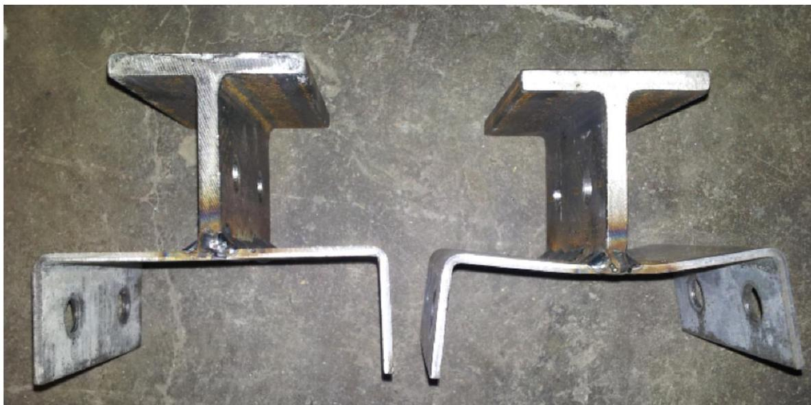
Figura 7.13 – Peça da ligação viga pilar antes e depois dos ensaios
