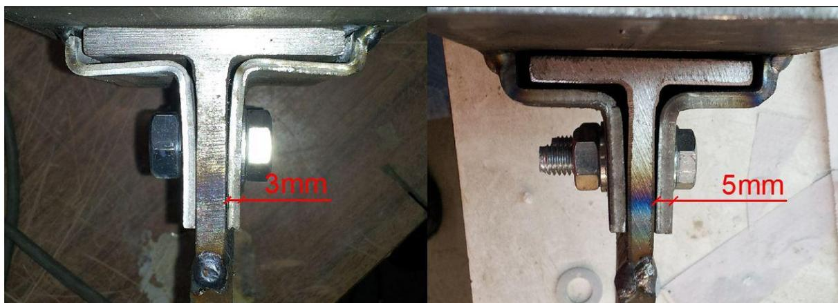
Figura 3.2 – Pormenor da diferença de espessuras nos provetes ensaiados
