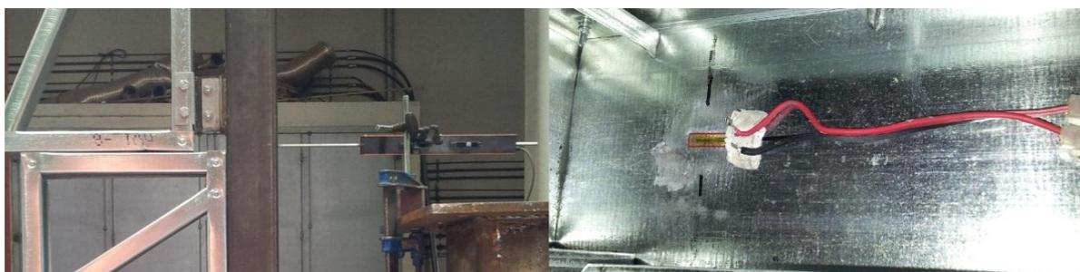
Figura 3.14 – À esquerda um dos deflectómetros usados e à direita um extensómetro
