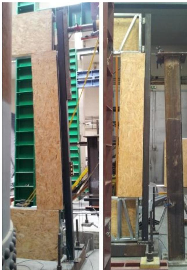
Figura 7.9 – Duas perspectivas da deformação observada no 4º ensaio
