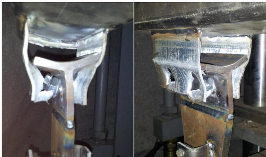
Figura 7.2 – Modo de rotura da ligação à tracção
