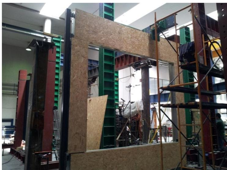
Figura 7.6 – Pórtico do 2º ensaio
