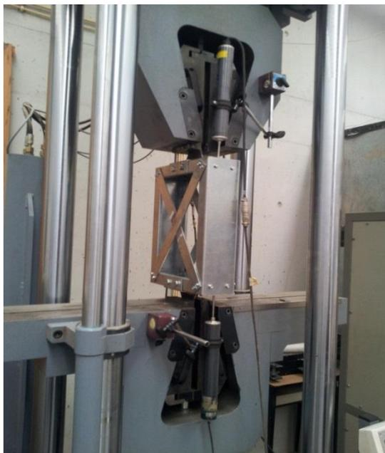
Figura 3.7 – Ensaio da treliça à tracção já instrumentada
