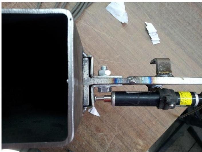
Figura 3.4 – Um dos lados do provete com o deflectómetro já colocado
