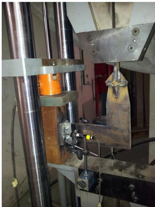
Figura 3.9 – Provete para o ensaio da ligação à flexão
