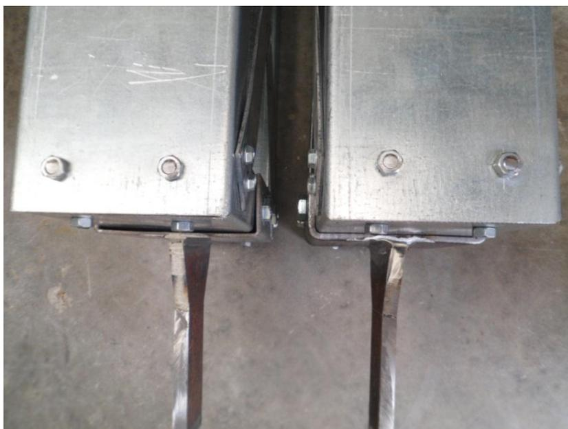
Figura 3.6 – Provetes a ensaiar com diferentes espessuras na ligação
