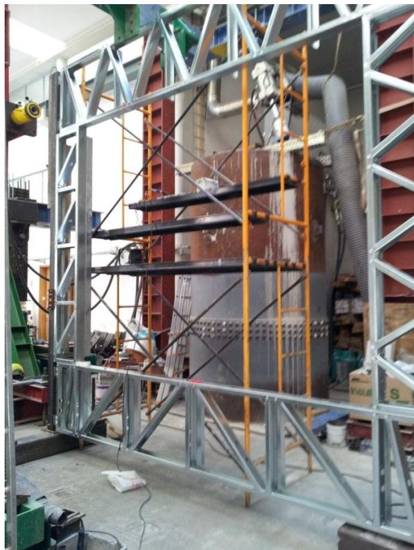
Figura 7.5 – Pórtico do 1º ensaio
