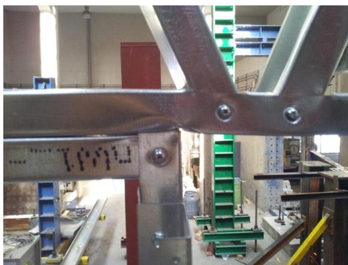
Figura 7.8 – Pormenor do empenamento assinalado com o círculo amarelo na Figura 4.1
