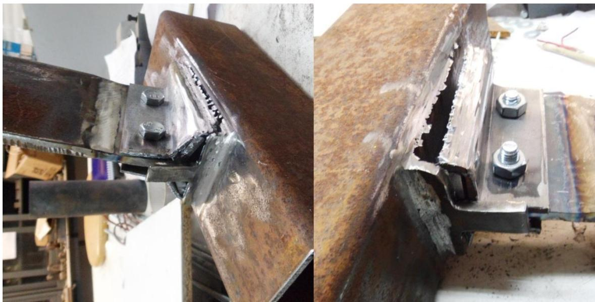
Figura 7.3 – Modo de rotura da ligação à flexão
