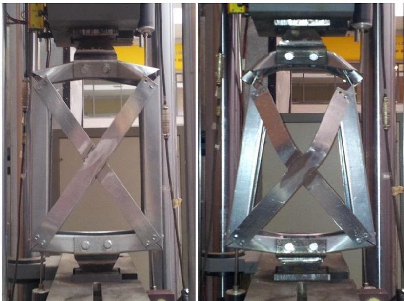
Figura 7.4 – Modo de rotura da treliça à tracção
