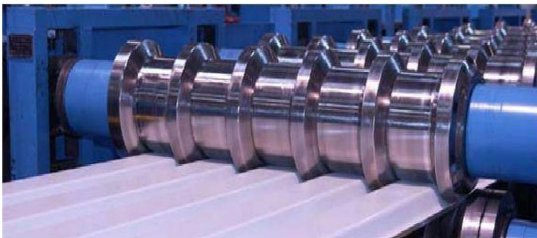
Figura 2.2 – Produção de aço enformado a frio (Veríssimo, 2008)
