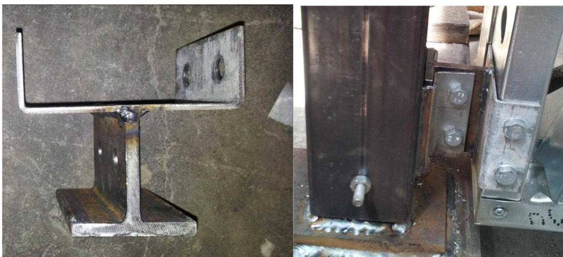
Figura 3.1 – Peça da ligação isolada e pormenor da ligação depois de montada
