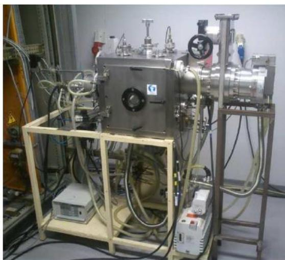
Figura 3.2. Equipamento de marca *Hartec*, usado para as deposições dos filmes.
