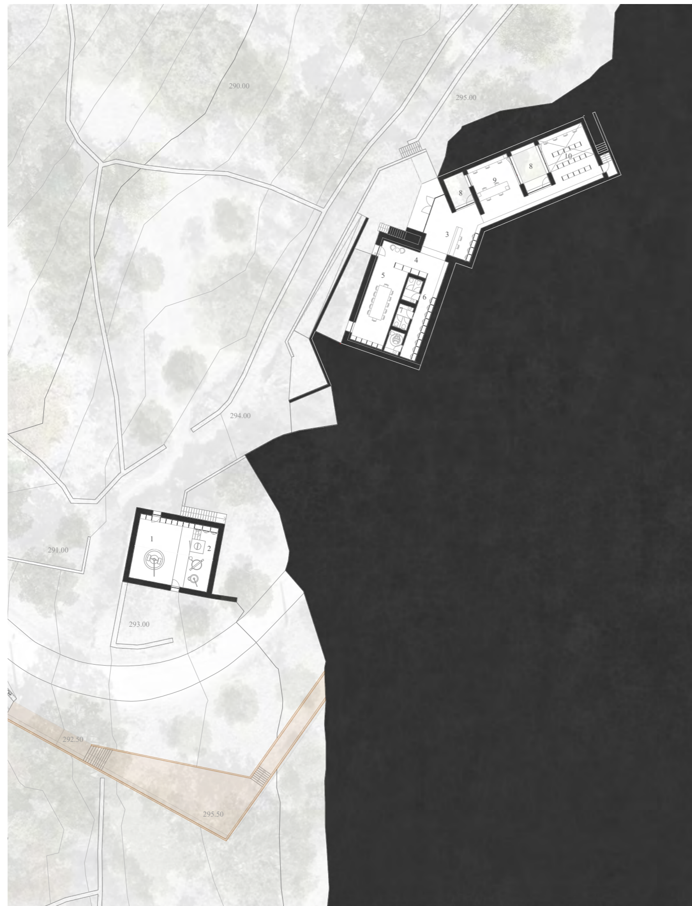
Legenda: Lagar de azeite: 1. Entrada/ Espaço de produtos endógenos/ Zona de moagem 2. Zona de enfeitamento e prensagem Complexo de investigação: 3. Entrada/ Foyer/ Recepção 4. Espaço estar investigadores 5. Sala de reuniões 6. Espaço de circulação e arrumação 7. Instalações sanitárias 8. Pátio 9. Laboratório 10. Biblioteca/ Arquivo 0 10 15
