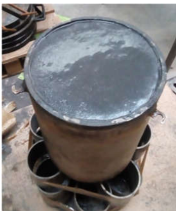
Figura 32- Aparência do bloco tipo Moncorvo logo após retirada da carga de consolidação.
