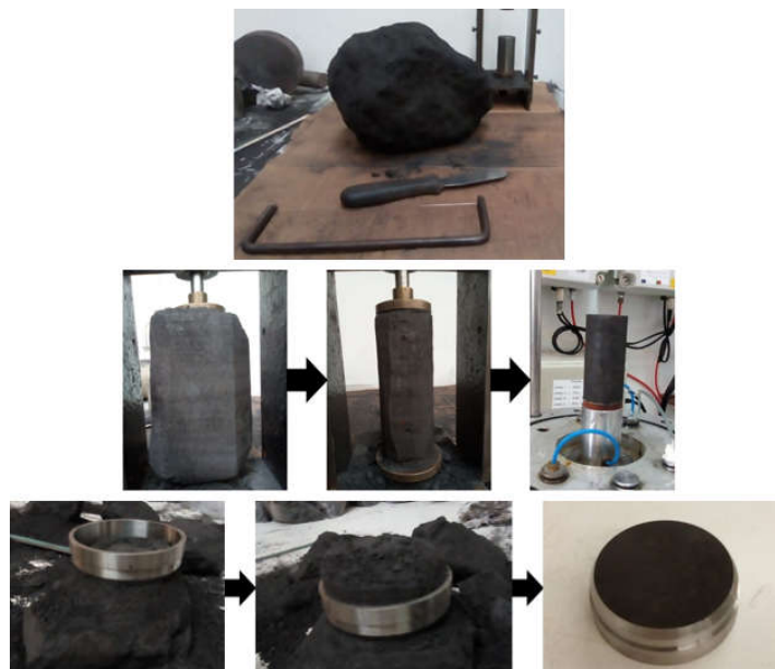
Figura 27 - Exemplo de produção de amostras indeformadas para ensaios triaxiais e edométricos.
