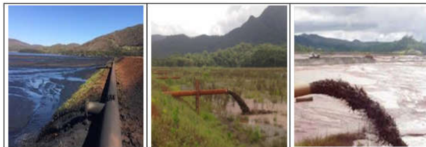
Figura 6 – Lançamento dos rejeitos nos locais de deposição final em lagos de decantação (Adaptado de Oliveira, 2020).
