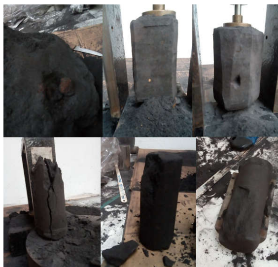
Figura 28- Falhas apresentadas por amostras indeformadas.
