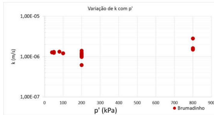
Figura 49 - Resultados dos ensaios de permeabilidade realizados pós etapa de consolidação dos ensaios triaxiais nas amostras indeformadas tipo brumadinho.
