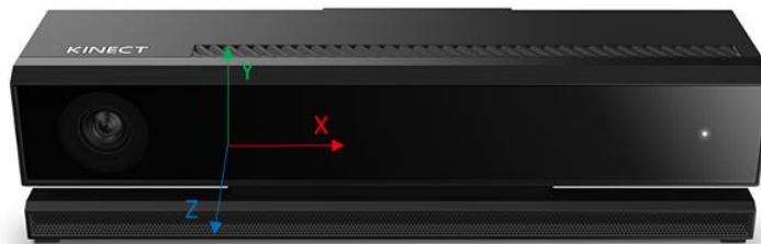
Figura 0.8 - Sistema de coordenadas 3D usado pelo Kinect (“Coordinate mapping”, n.d.)
