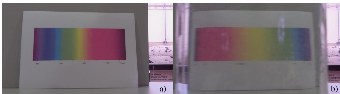
Figura 4.8. Espectro de cor capturado a) diretamente e b) através de um meio aquático.
