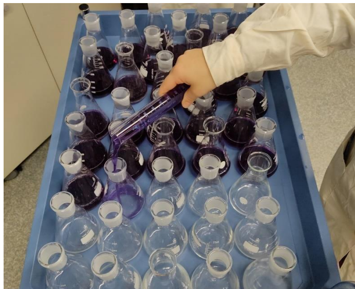
Figura 2 - Distribuição do meio líquido (Caldo de MacConkey) em balões de Erlenmeyer, para posterior esterilização (Fonte: próprio)
