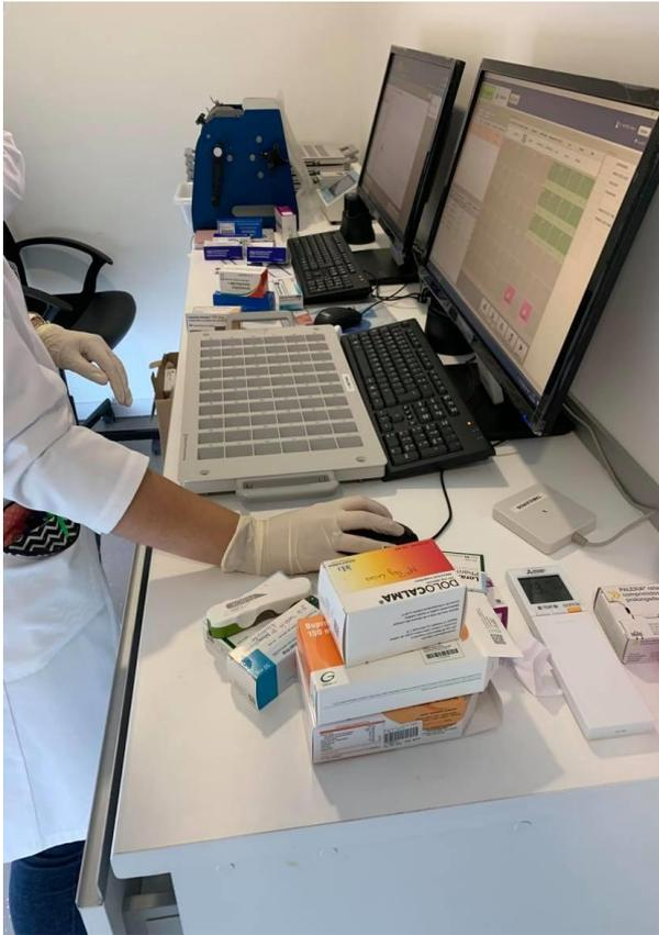
**Figura 3.** Sistema informático manuseado pela farmacêutica Beatriz Grilo. O tabuleiro que se apresenta na figura destina-se à colocação manual dos medicamentos não padronizados em *canisters*. A colocação manual dos comprimidos no tabuleiro é, mesmo assim, auxiliada pelo sistema informático, que indica a quantidade de comprimidos a colocar e o respetivo alvéolo.
