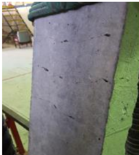
شکل ۳-۱۹: ستون بتنی مسلح GFRP با خروج از مرکزیت بزرگ (G150-45) [۳۶]
