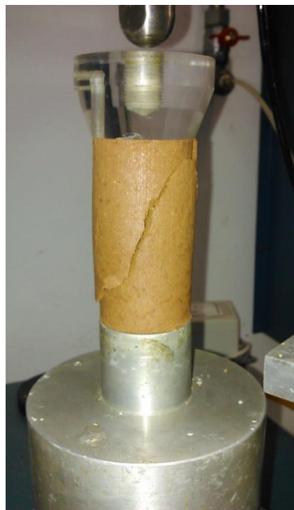
Figura 4.7 – Exemplo de provete após a realização de um ensaio UCS.
