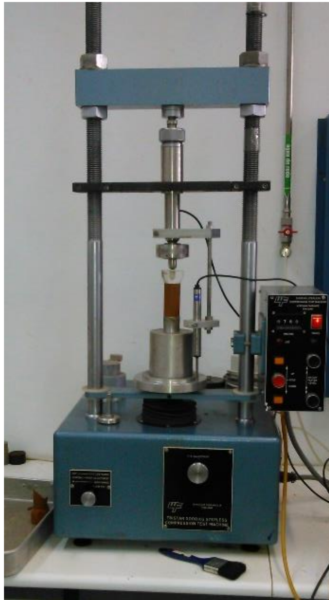
Figura 4.5 – Equipamento para ensaios UCS: Prensa de capacidade de carga até 20 kN.
