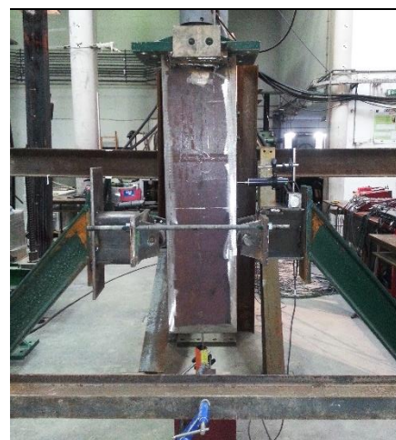
b) Travamento da Viga 2.
