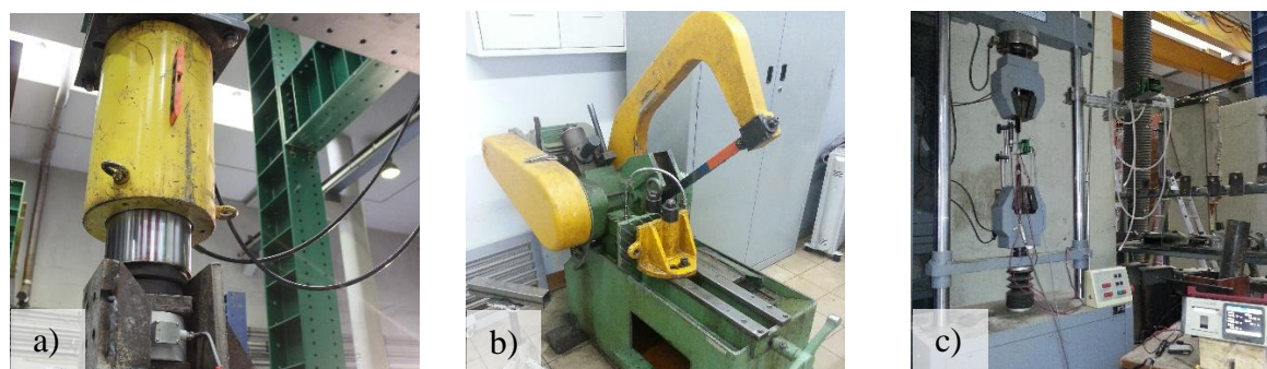
Figura 3.2 – Equipamentos laboratoriais: a) Macaco hidráulico; b) Serra mecânica; c) Prensa.
