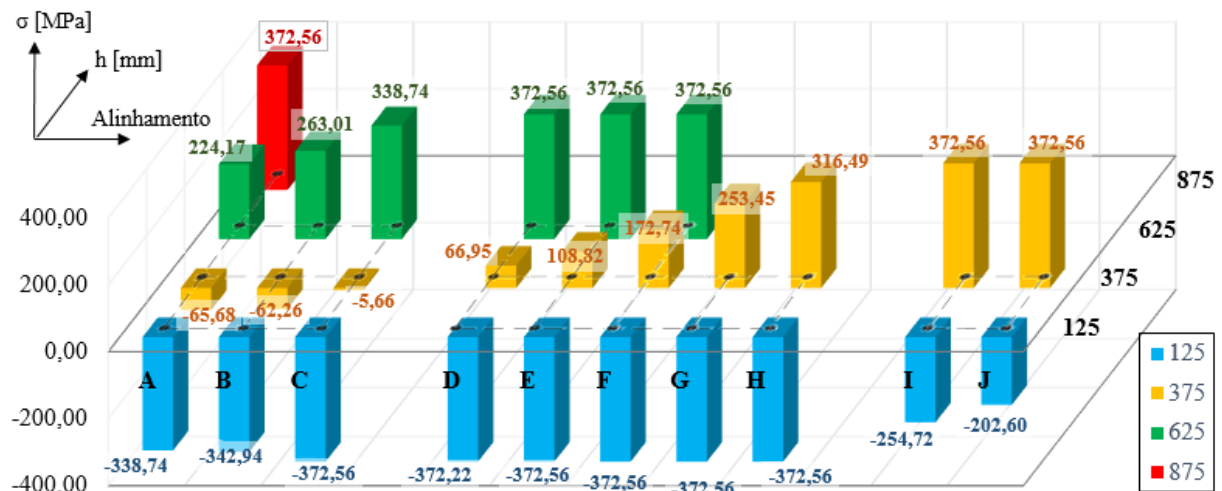
Figura 4.21 – Distribuição das tensões longitudinais na alma da Viga 1 para a carga última real ( P_{ult,Real} = 1205,24\text{kN} ).
