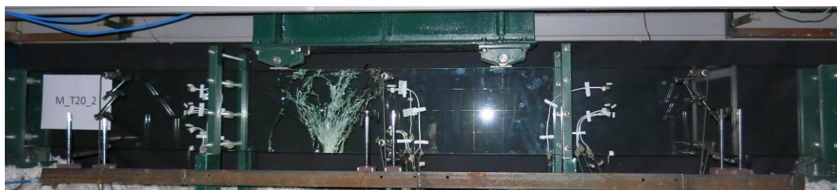
Figura 3.43 – Vista global do padrão de fratura do ensaio TA_2
