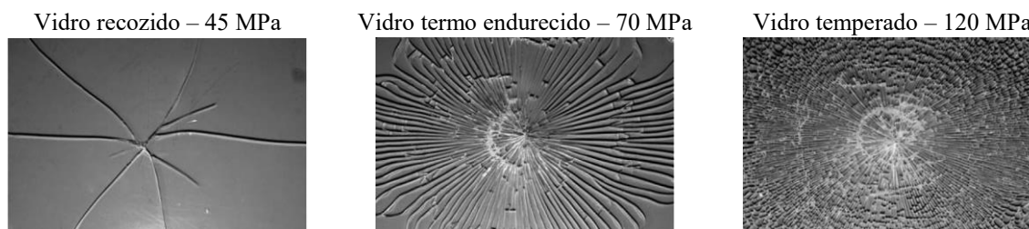
Figura 2.7 - Padrão de fratura e capacidade de resistência à flexão, para o vidro recozido, o vidro termo endurecido e o vidro temperado, (adaptado de Louter, 2011)
