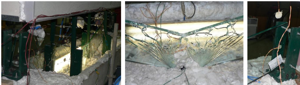
Figura 3.58 – Pormenorização do padrão de fratura do ensaio T80_1, Ponto C – colapso da viga
