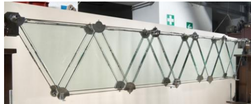
Figura 2.15 – Vigas de vidro pré-esforçadas em forma de treliça, (Froli e Lani, 2010)
