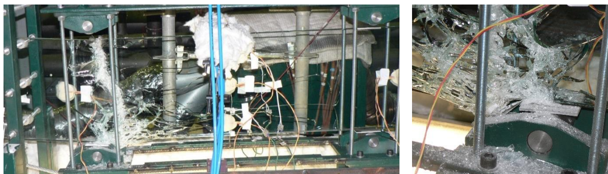
Figura 3.99 – Padrão de fratura resultante, PS_T80_0
