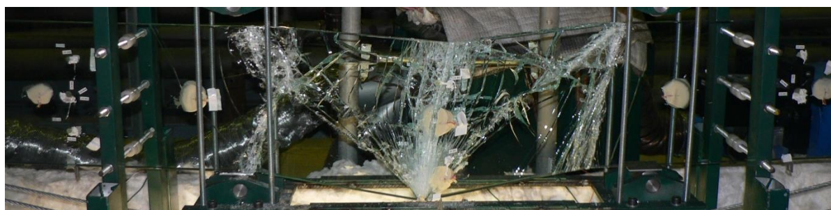
a) Padrão de fratura final resultante
