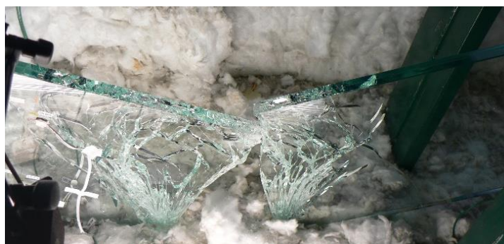
Figura 3.42 – Padrão de fratura do ensaio TA_1: Ponto E – Colapso
