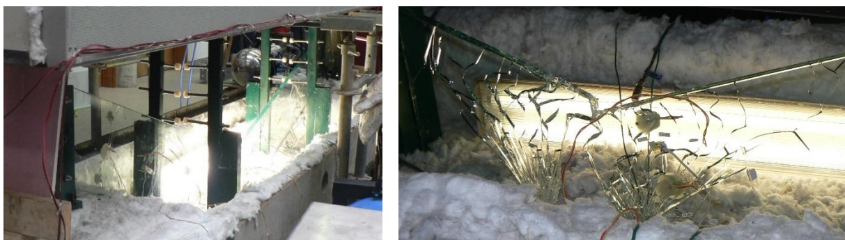
Figura 3.59 - Pormenorização do padrão de fratura do ensaio T80_2: Ponto C – colapso da viga
