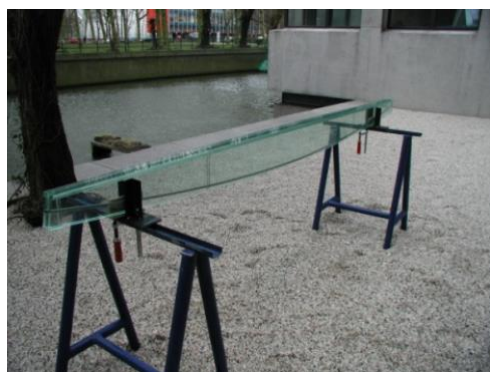
Figura 2.14 – Viga em T, parabólica, reforçada e pré-tensionada (Louter, 2011)
