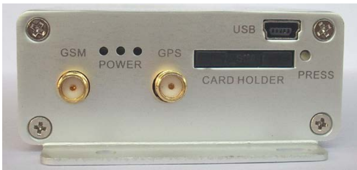
Figura 53 – Saídas para as antenas externas do dispositivo TZ-AVL05
