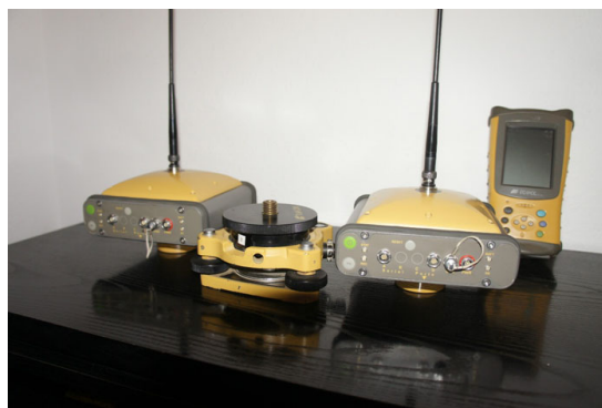
Figura B.3: Sistema TopCon HiperPro
