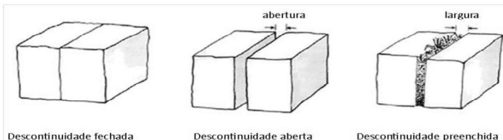
Figura 3.1 – Ilustrações relativas das aberturas das descontinuidades (adaptado de ISRM, 1978).
