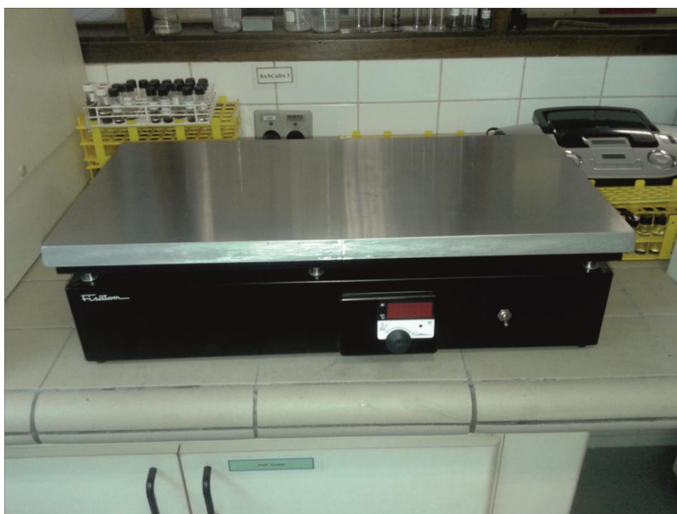
Figura III.8. Placa de aquecimento para preparação de lâminas (LAFO – UFRJ).
