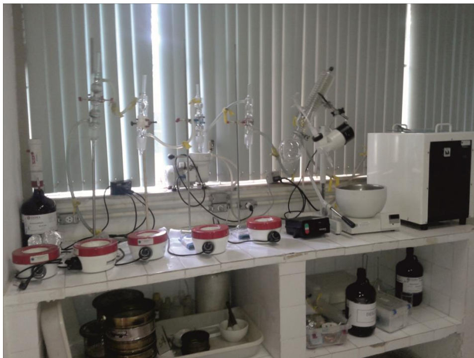
Figura III.9. Extrator Soxhlet e evaporador rotativo a vácuo (LAFO – UFRJ).
