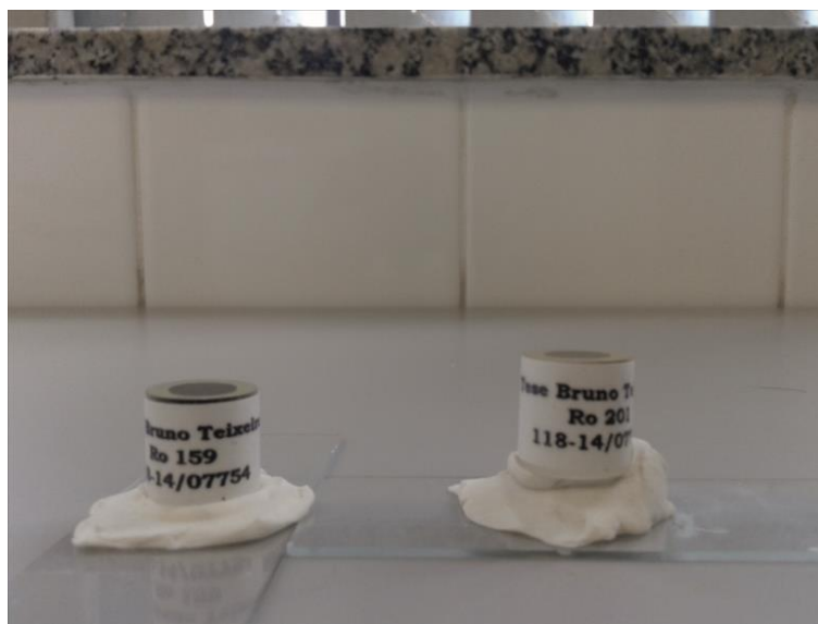
Figura III.12. Plugs de concentrado de querogénio das amostras analisadas (equivalentes às amostra R4 (= Ro159) e R12 (= Ro201)).
