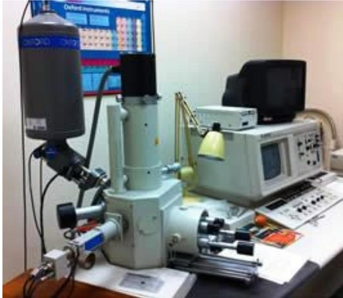
**Figura III.4: Microscópio electrónico de varrimento (SEM) equipado com detector de energia dispersiva de raios X (EDS).**
