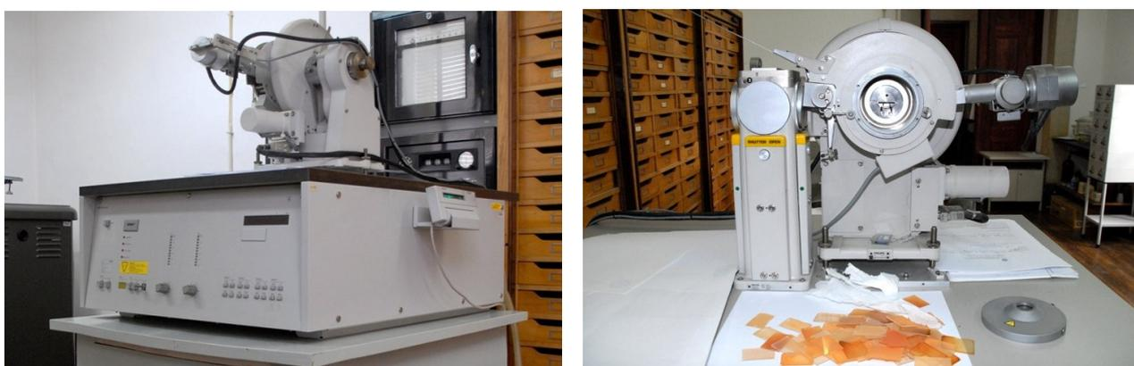
**Figura III.8: Difractómetro de raios-X**
