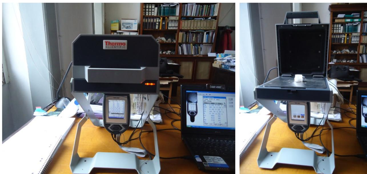
Figura III.3: Espectrometria por Fluorescência de Raios-X (XRF)
