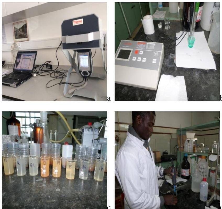
Figura 14: a) Espectrómetro portátil utilizado para análises químicas das amostras de solos; b) medidor pH Hanna modelo pH21 calibrado com solução pH 4 e pH7;c) decantação das amostras CE; d) análise a condutividade elétrica.
