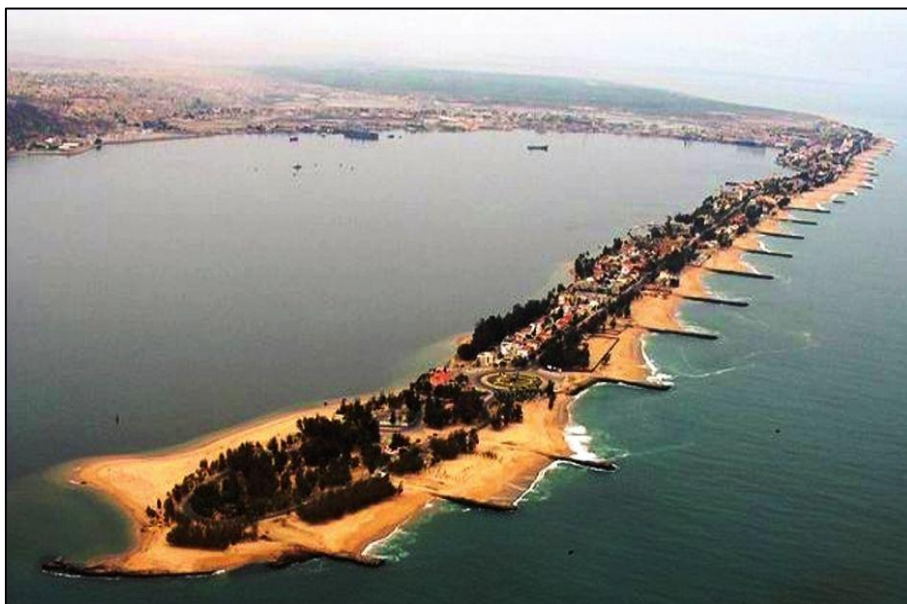
Fig. V. 9 – Vista aérea da morfologia da restinga do Lobito susceptível aos factores intrínsecos e antrópicos. As obras transversais de protecção (esporões) protegem-na na eventual dinâmica costeira (foto obtida a partir de http://www.cpires.com/docs/lobito_2004_ )
