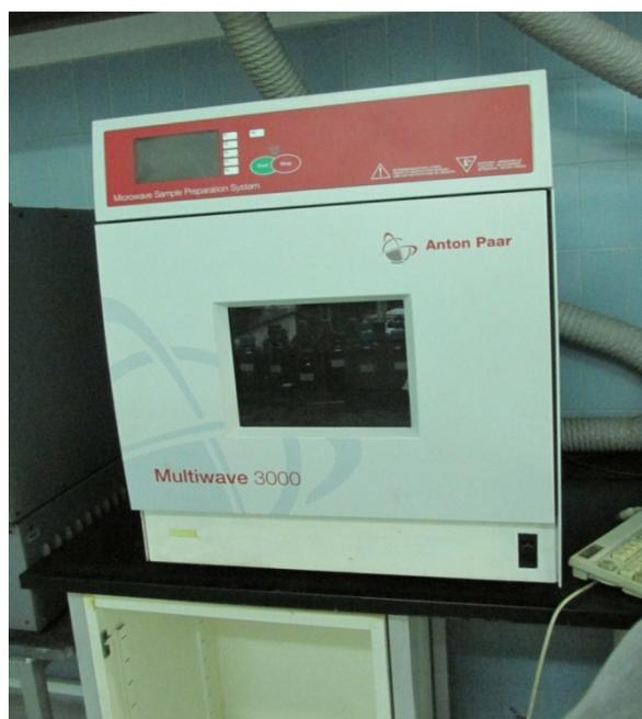
Figura 4.25 - Microondas (Anton Paar-Multiwave 3000; foto: P. Cassavela).
