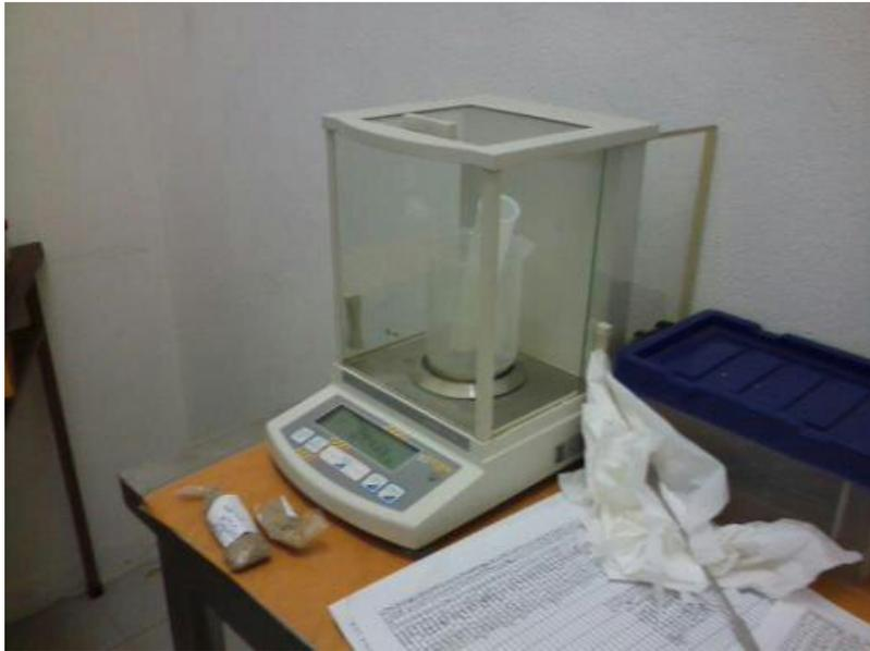
Figura A1- Balança (instrumento usado na pesagem das amostras).
