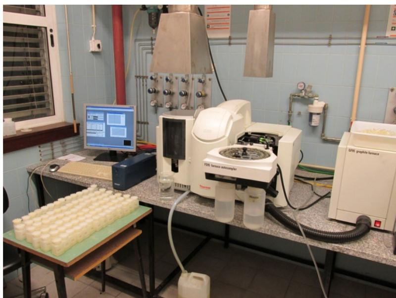
Figura 4.26 - Espectrofotómetro de Absorção Atómica (foto: P. Cassavela)
