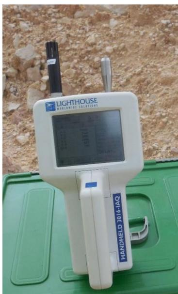
Figura 4.6: Medidor de partículas Handheld 3016 – IAQ
