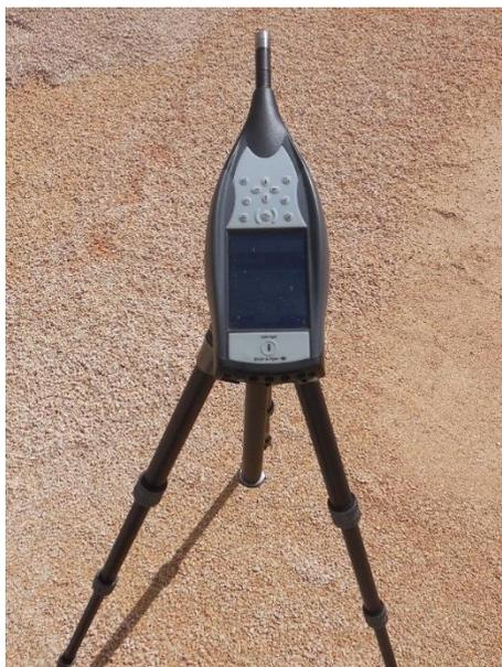
Figura 4.4: Sonómetro 2250-L da Brüel & Kjær
