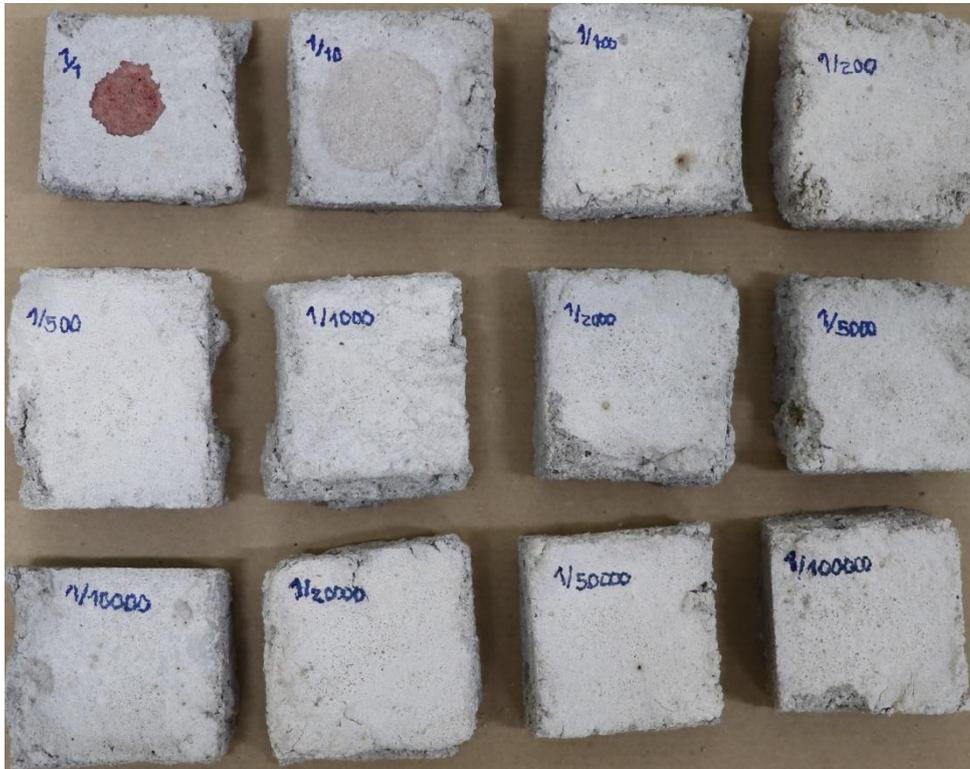
**Figura A1.** Aspeto das diluições de sangue no substrato cimento.
