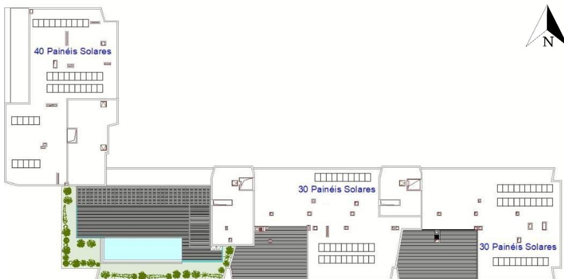
**Figura 3.24.** Distribuição dos coletores solares pela cobertura do Aparthotel.
