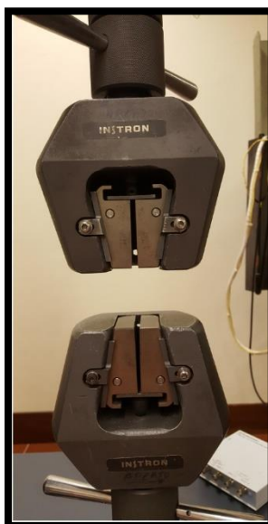
Figura 7: Amarras utilizadas nos testes efetuados
