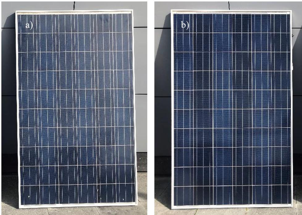
**Figura 3.1** – Comparação dos aspetos de um painel: a) antes da limpeza; b) após limpeza .
