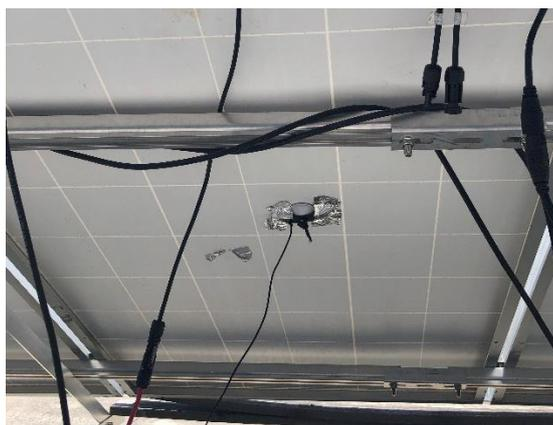
**Figura 3.6** – Posicionamento da sonda de temperatura na face posterior do painel.
