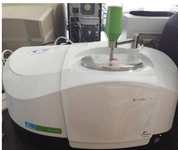
Figura 14. Espectrômetro PerkinElmer com UATR Two utilizado no trabalho experimental
