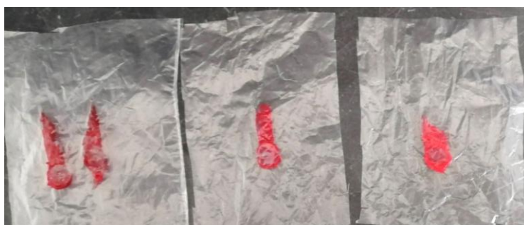
Figura 12. Demonstração da aplicação da amostra para análise direta
