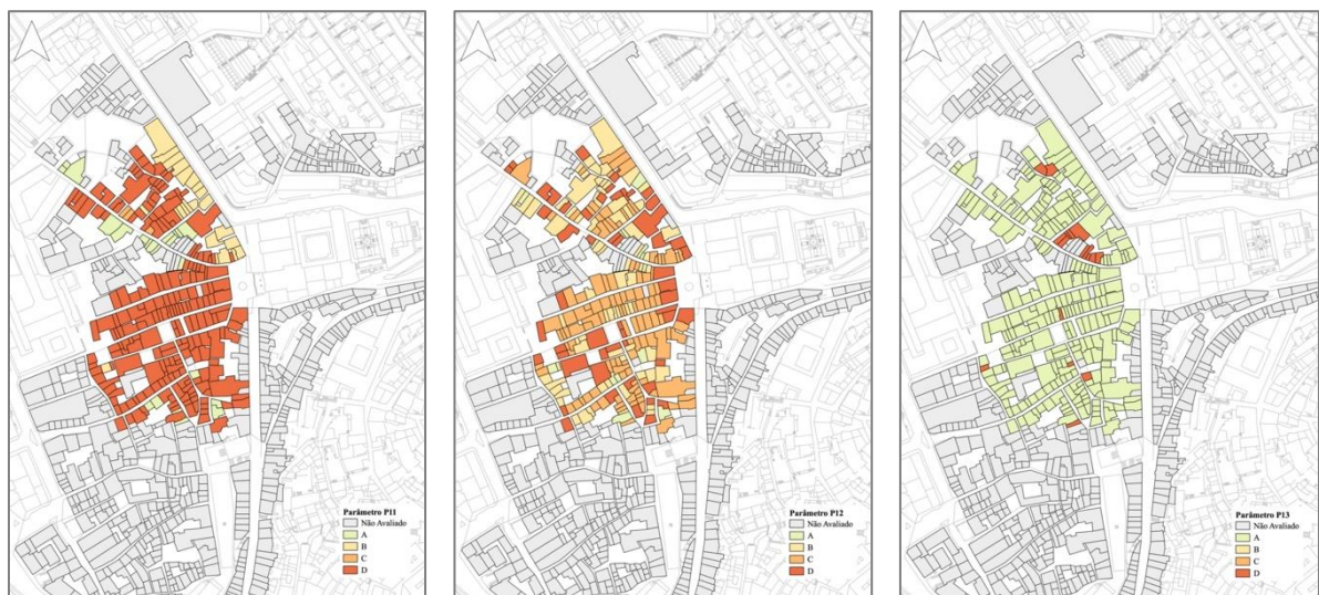
Figura 52: Mapas com a distribuição dos parâmetros P11, P12 e P13: “Elementos beneficiadores do comportamento”, “Efeito de Pounding” e “Tipo de Estrutura do pavimento”
