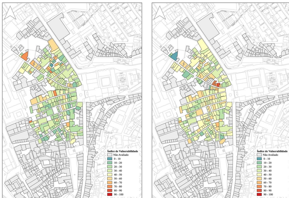
Figura 57: Mapas da vulnerabilidade das paredes de fachada em 2009 (à esquerda) e 2020/2021 (à direita)
