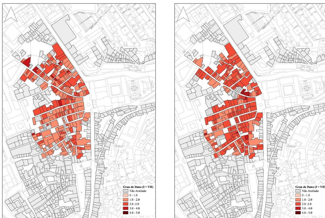
Figura 59: Cenários de grau de dano para intensidades I (EMS-98) =VII, em 2009 (à esquerda) e em 2020/21 (à direita)
