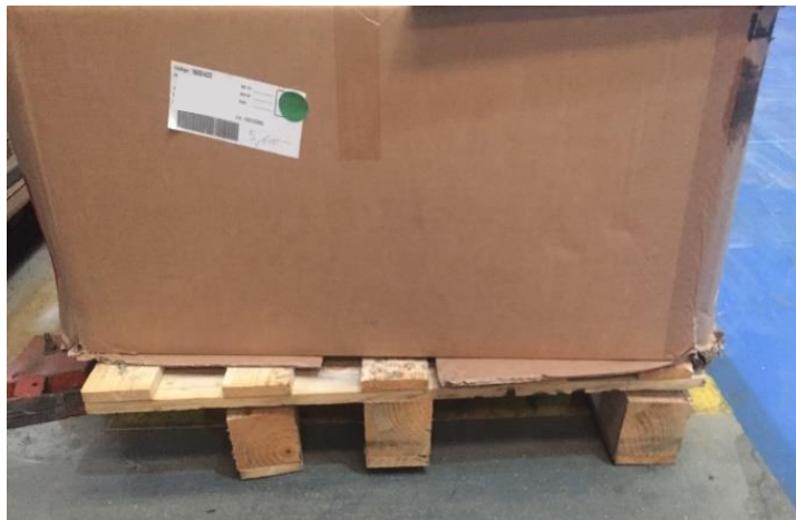
Figura 4.10. Pallet danificada em frente às estantes
