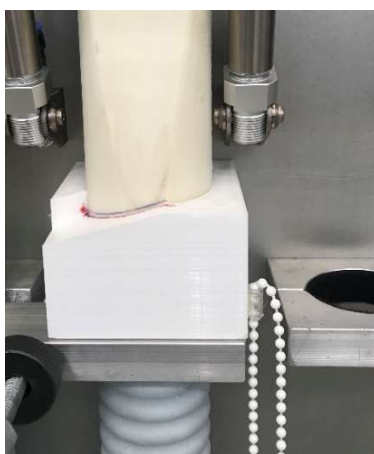
Figura 21 – Gabarit de medição fixo à máquina de secagem
