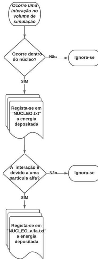
Figura 22 Lógica usada para guardar os dados das interações que ocorrem no Núcleo. Este fluxograma procura explicar de forma simples o código usado para registar em 2 ficheiros de texto distintos a energia depositada em cada interação e a partícula responsável pela interação, com o Núcleo.
